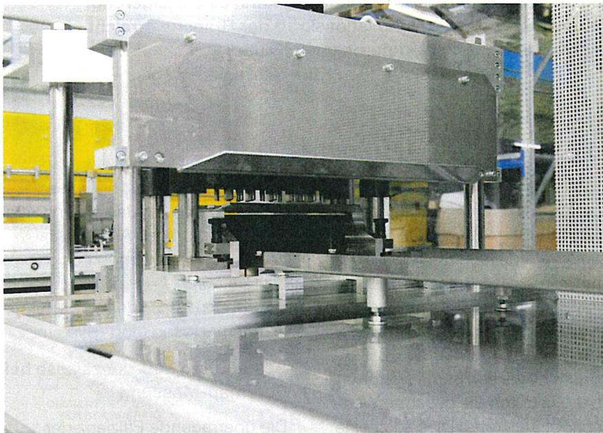
Bild 3: Stanzeinheit ME4 mit Stanzwerkzeug
